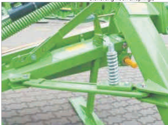
Wenn die Sicherung zu oft anspringt, soll man die Feder zusätzlich um 1-2 mm zusammendrücken.
