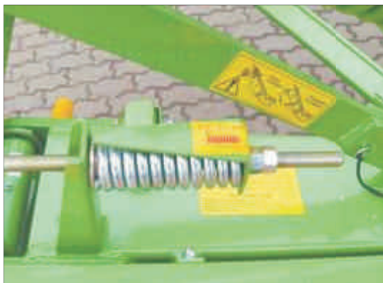
Bei Keilriemenspannung muss man beachten, dass der Abstand zwischen Zeiger am Feder und Gehäuse mindestens 0,5 mm betragen muss.
