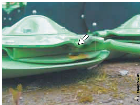
Außer den Messern zerschleißen sich aus die Messerhaltebolzen
