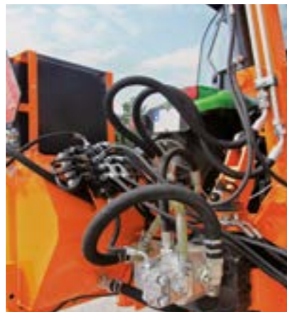
Conjunto hidráulico con válvulas selectoras multibloqueo - duradero y eficiente.
