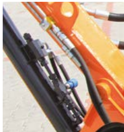
Bloqueo hidráulico en el cilindro principal junto con una válvula de cierre ajustable.
