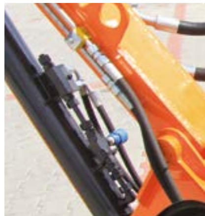
Dispositif de verrouillage hydraulique sur le vérin principal avec vanne d'étranglement réglable.
