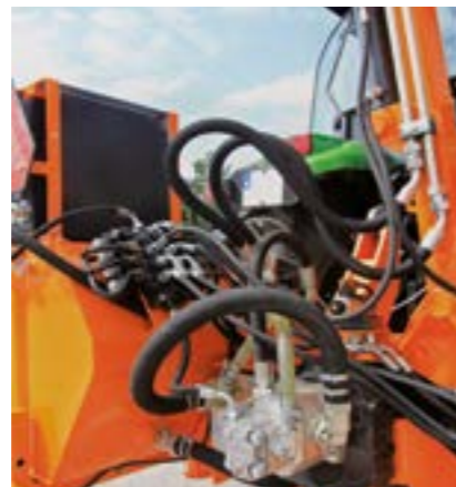
Système hydraulique avec distributeur - puissant et robuste.
