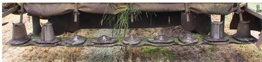
Belka tnąca adaptera Samasz Z015 składa się z dziewięciu dysków i ma szerokość roboczą 3,7 m.
