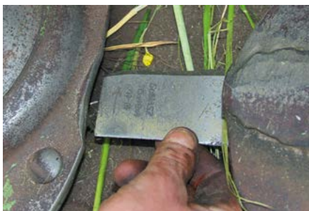
Zbyt długie ostrza w maszynie Grzegorza Wielgosza weszły w kontakt z sąsiednimi dyskami. Producent już to poprawił i zamiast noży o długości 115 stosuje obecnie elementy o 1 cm krótsze.
