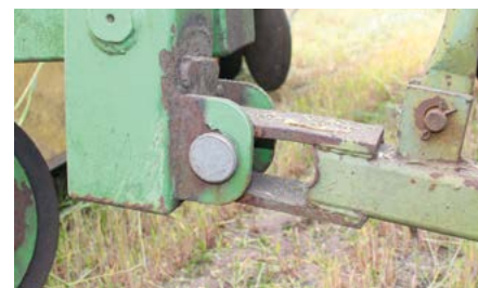
Do czteropunktowego tączenia kosiarki z pojazdem służą w górnej części spoczywające na hakach pokosówki czopy przystawki, zaś u dołu przekładamy sworznie z zawleczkami przez uszy adaptera i fasolkowe otwory Fortschrittki.
