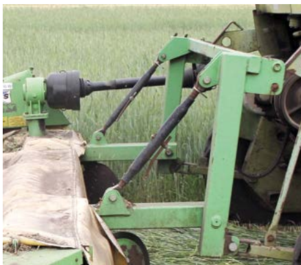
Widoczne śruby rzymskie służą do regulacji wysokości cięcia tanu.
