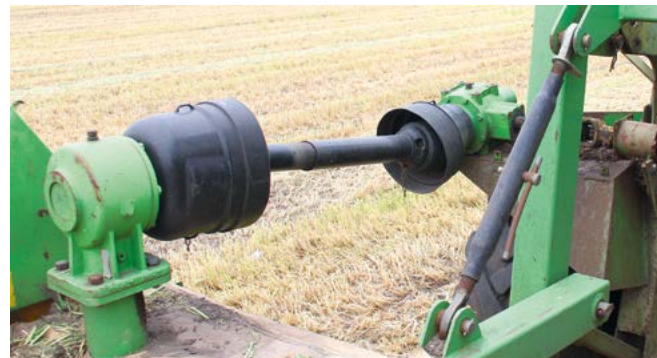
Kosiarka Samasz korzysta z wyprowadzonego z prawej strony wałka o prędkości 1000 obr./min.
