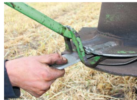
Do prawego słupka portalu zaczepowego przyspawane są uchwyty dla dźwigni rozporowej do szybkiej beznarzędziowej wymiany nożyków. ➔
