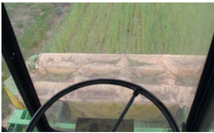
Kabiny Fortschritt nie grzeszą komfortem i polem widzenia. Mimo to obserwacja przystawki jest lepsza w porównaniu z kosiarką montowaną z tyłu bądź z przodu ciągnika.
