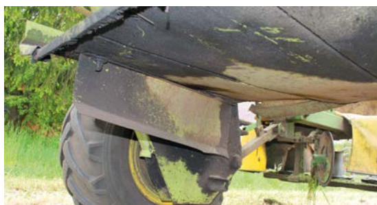
Kosiarki pokosowe Fortschritt mają zintegrowany własny układ regulacji szerokości pokosu. Służy on raczej do bardziej obfitych łąk.
