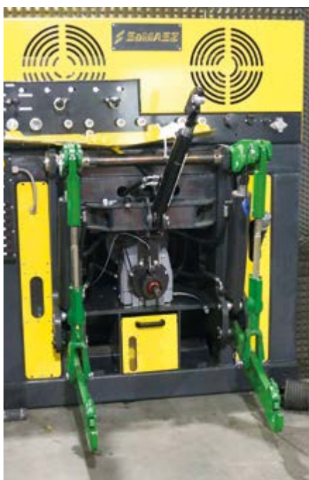
Stanowisko testowe maszyn Samasz zawieszanych na TUZ.
