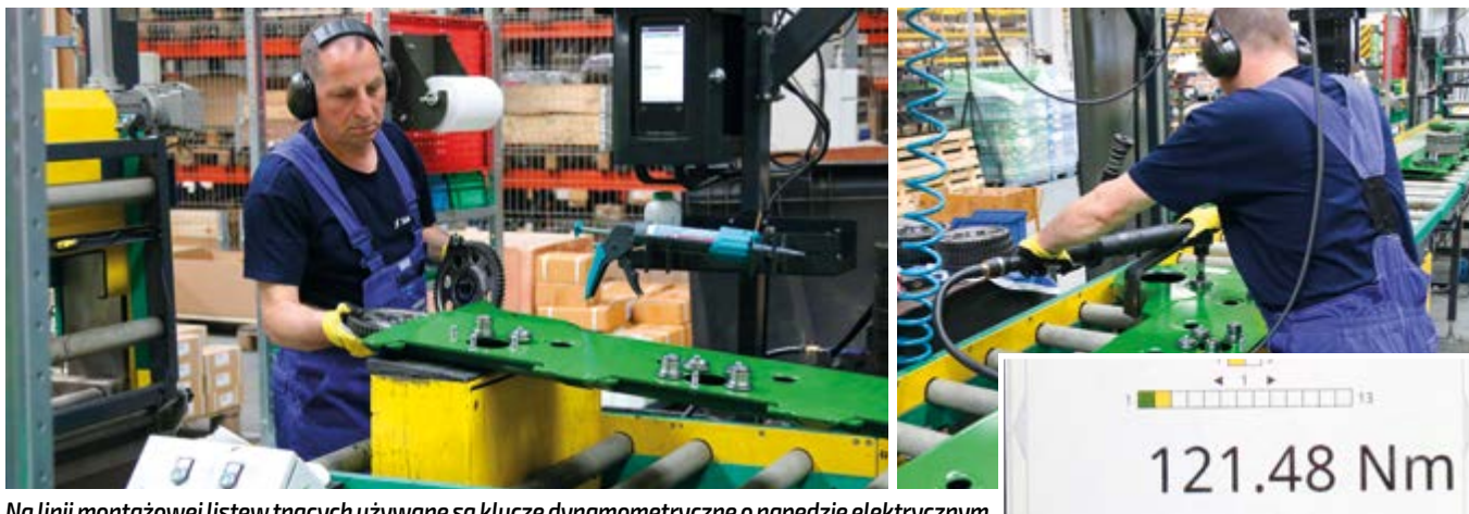
Na linii montażowej listew tnących używane są klucze dynamometryczne o napędzie elektrycznym.
