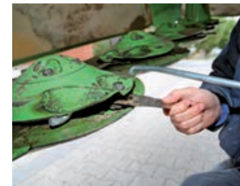
Messenwissel is standaard, met slijtvaste mesbouten en een zeer goede, slipvaste snelwisselsleutel.
