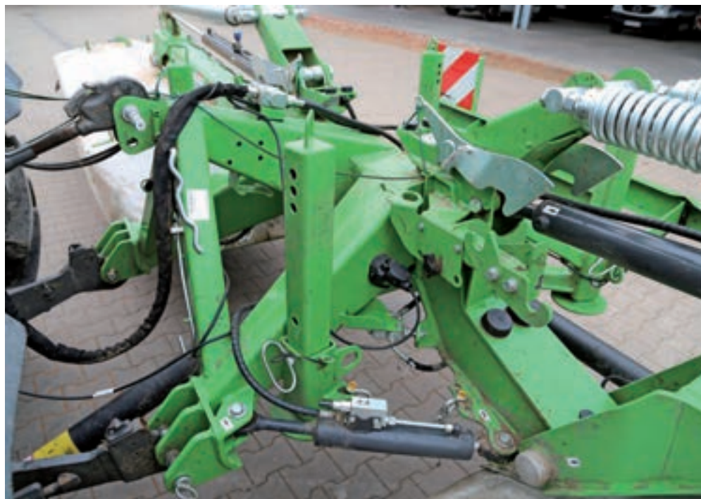
De aanbouwboek van de achtermaaiers is eenvoudig, maar voldoet prima. Qua hydrauliek heb je standaard drie enkelwerkende ventielen nodig voor in-/uitklappen, en het uitheffen en laten zakken op kopakkers.
