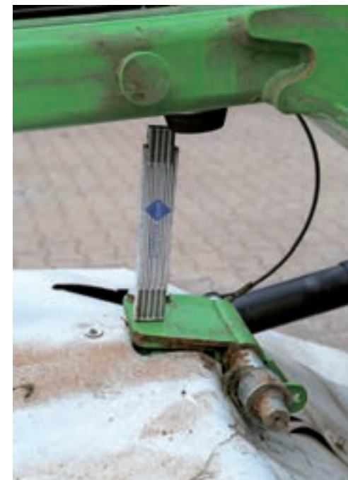
Als er een duimstok tussen de draagarm en de rubberen stop van de achtermaaiers past, heb je de juiste hoogte.
